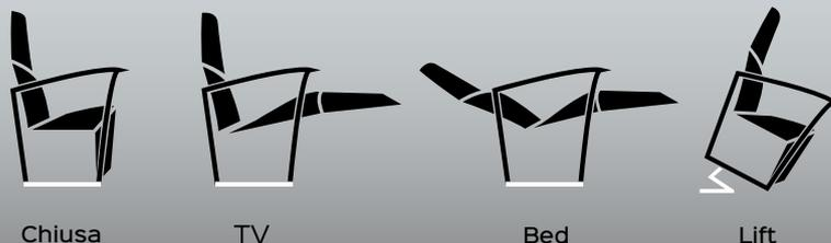
**Benefit:** I meccanismi KEYMOTION sono costruiti interamente in Italia, dalla materia prima, alle lavorazioni, fino all'assemblaggio e collaudo finale. I prodotti sono accuratamente controllati prima di essere spediti. Questa meccanica è dotata di un flap che aumenta l'estensione della pediera (migliorando il comfort), nelle posizioni tv e full relax. Due motori regolano le diverse posizioni: chiusa, tv, bed e lift. Il primo attuatore, oltre a portare l'imbottito in posizione Lift, estende la
